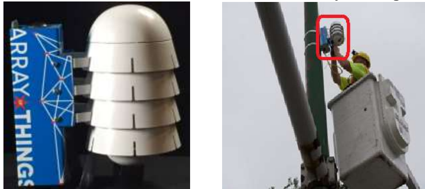
図表 12: プロジェクトのために開発されたセンサ「Array of Things」
