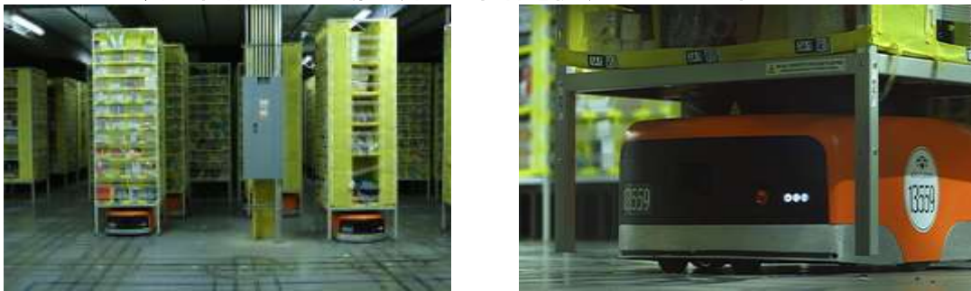
図表 9: 商品棚の下に潜り、棚ごと商品を移動させる Kiva 社のロボット
