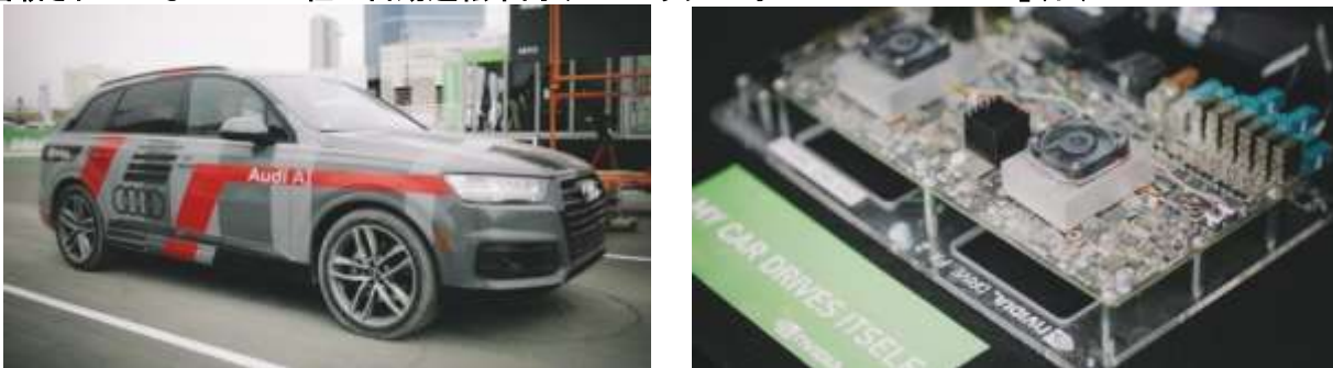
図表 13: Audi 社と NVIDIA 社が共同開発した AI 自動運転車のコンセプトカー(左)と同コンセプトカーに搭載されている NVIDIA 社の自動運転車向け AI プラットフォーム「DRIVE PX 2」(右)
