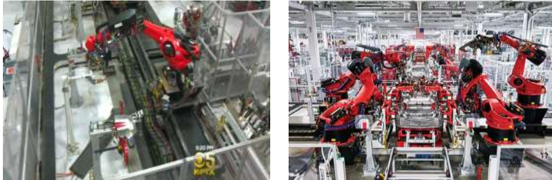
図表 19: Tesla 社の自動車製造ラインに導入されている KUKA 社製ロボット
