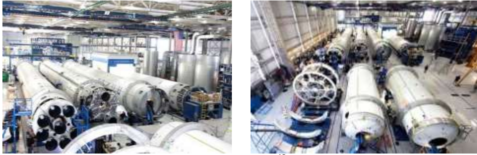
図表 10:カリフォルニア州ホーソーンの製造工場で組み立てられる SpaceX 社の「ファルコン 9」ロケット
