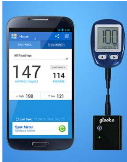
図表 15: Bluetooth を介して血糖値測定器からスマートフォンにデータを飛ばせる Glooko 社のハードウェアデバイス「MeterSync Blue」
