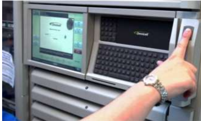
図表 12: バイオメトリクススキャナーを搭載した調剤キャビネット
